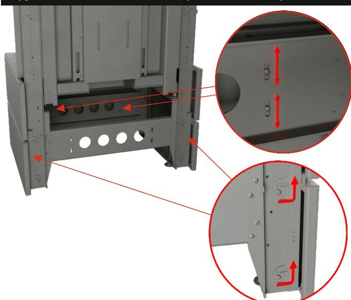
16 Установите панель «7» сверху на рамку, проверьте, остался ли выдержан размер 570мм между нижней и верхней полосой рамки, в противном случае отрегулируйте высоту винтами на уголках подвеса.
