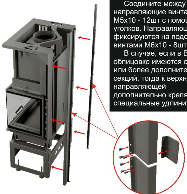
Соедините между собой направляющие винтами M5x10 - 12шт с помощью уголков. Направляющие фиксируются на подставке винтами M6x10 - 8шт.
